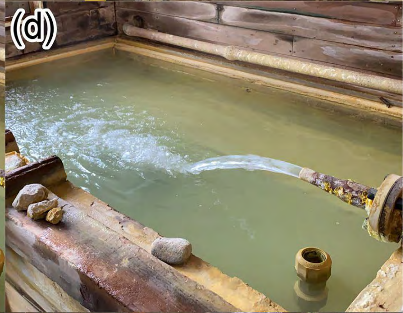
秋田県仙北市玉川温泉での藍藻類シートを使った金吸着実験
