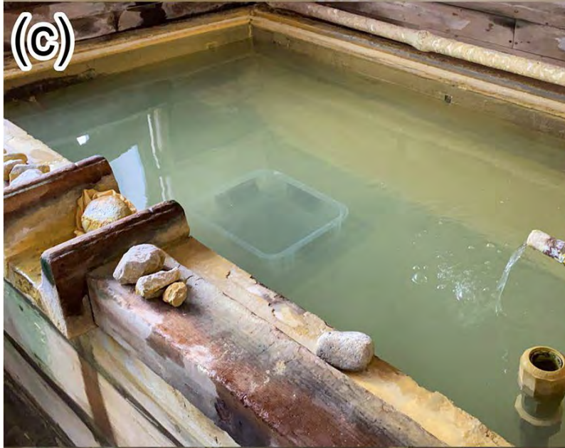
秋田県仙北市玉川温泉での藍藻類シートを使った金吸着実験
