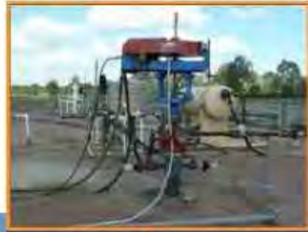
坑井ヘッド・ポンプ・セパレーター
