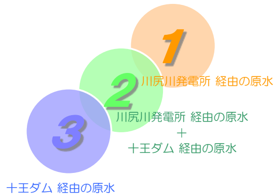
▶▶▶ 十王浄水場の取水パターン
