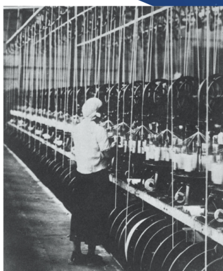
電線の編組作業の様子(1937年)
