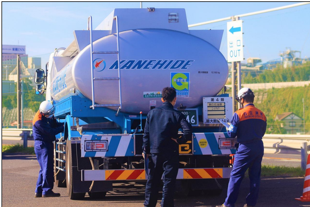
移動タンク貯蔵所の立入検査（浜の宮ロードパーク）
