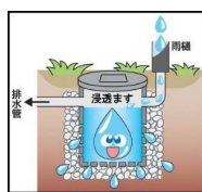
雨水浸透ます
