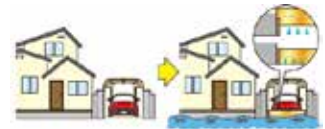
防水板設置工事
