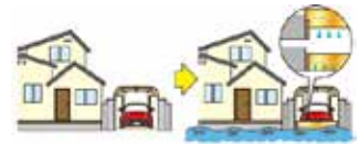
防水板設置工事
