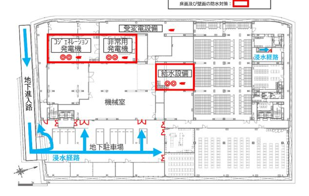
図45 免震層の止水化対策計画位置図(平面図)
