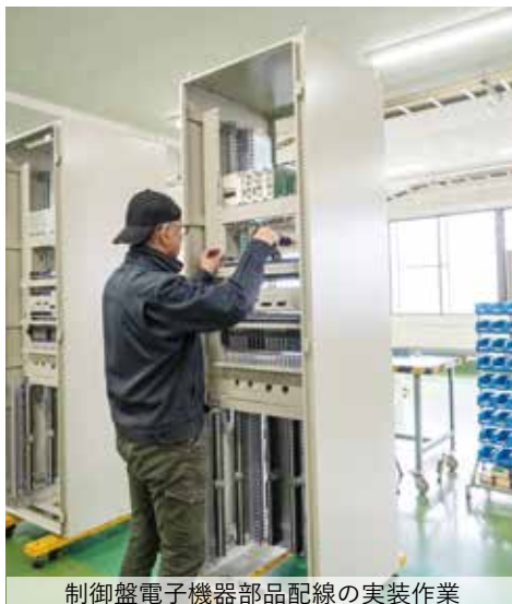
制御盤電子機器部品配線の実装作業
