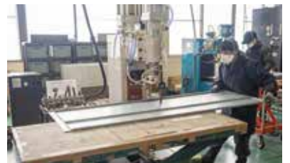
新規導入のスポット溶接機で作業を効率化
