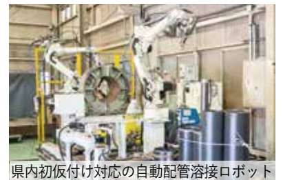
県内初仮付け対応の自動配管溶接ロボット
