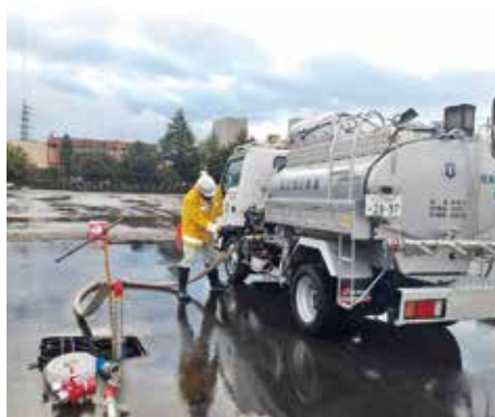
給水車への充水作業
