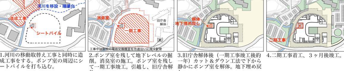
1. 河川の移動取替え工事と同時に造成工事をする。ポンプ室の周辺にシートパイルを打ち込む。
