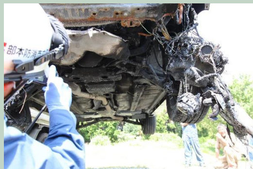
車両火災の火災調査
