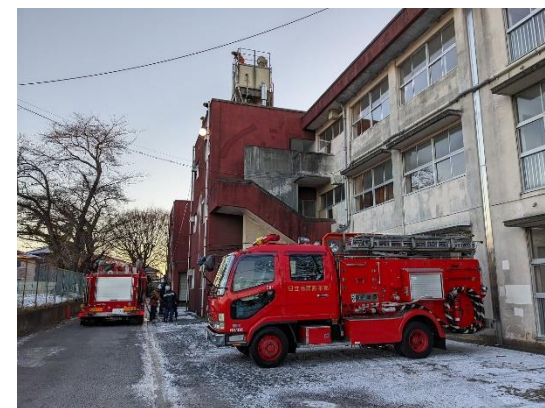
宮田小学校の高架水槽に給水を実施している様子
