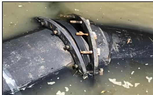
(原因：ボルト腐食による管の離脱)
