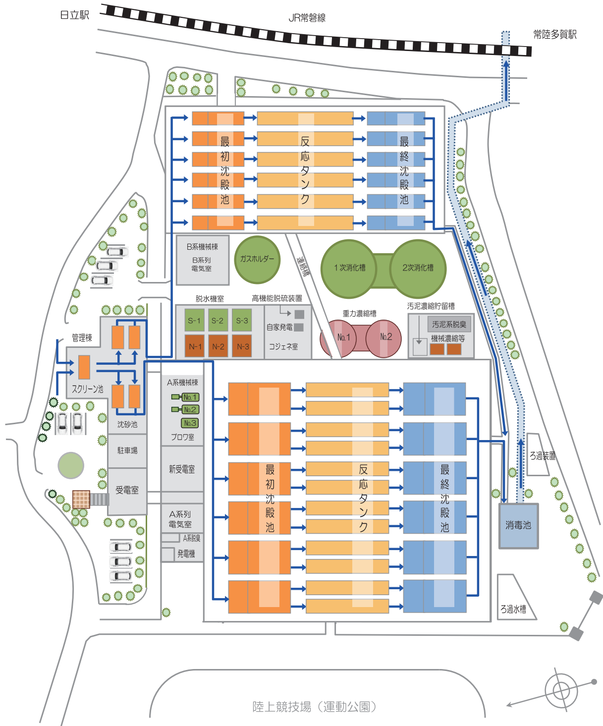
◎池の川処理場施設平面図
