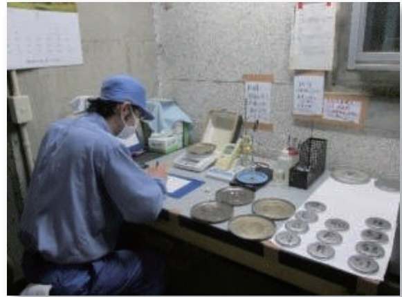
水質検査(大腸菌検査・汚泥分析)
