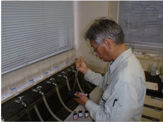
水質検査(残留塩素測定・金属分析)
