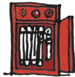
屋内消火栓設備
