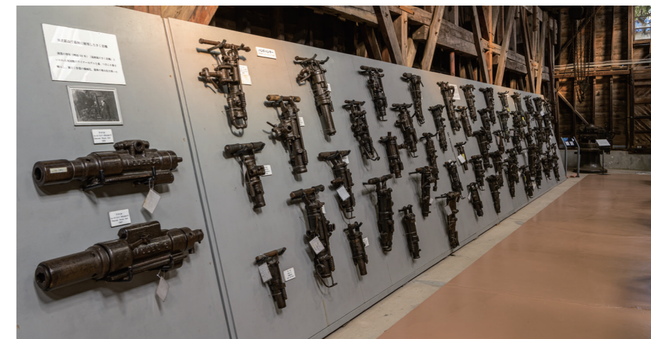
鉱山資料館内に展示される歴代の削岩機コレクション 時代の流れとともに、より小型化し高性能になっていく変遷を見ることができます。
