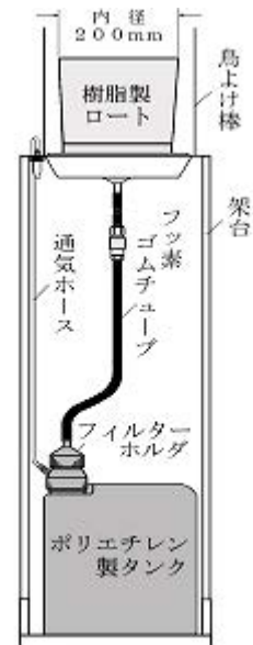
酸性雨ろ過式採取装置
